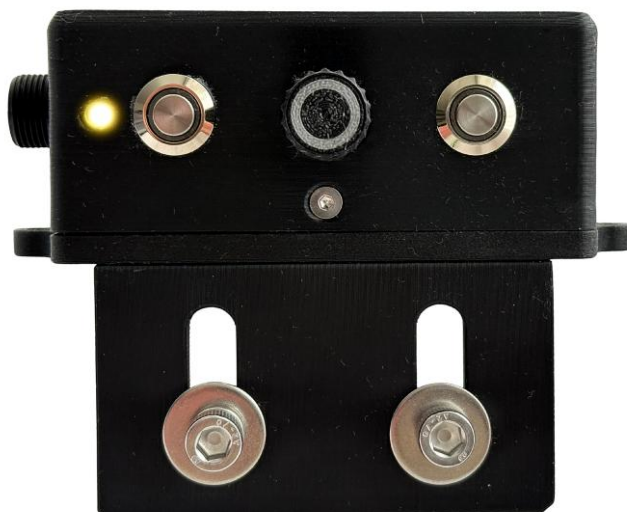
Рис. 20. Умова зміни швидкості — світиться лише світлодіод живлення, ліва кнопка не світиться
