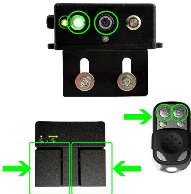
Рис. 19. Зміна кута автопошуку — крутилка, кнопки А і В на пульті, педалі
