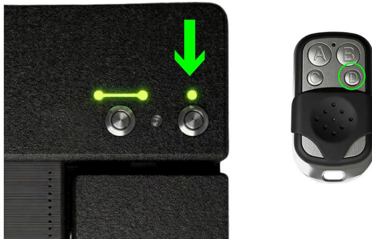
Рис. 17. Утримання напрямку в автопошуку — права кнопка педалі або кнопка D на пульті
