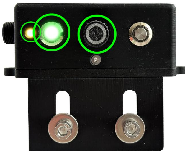
Рис. 14. Мануальне керування — обертання крутилкою на блоці керування
